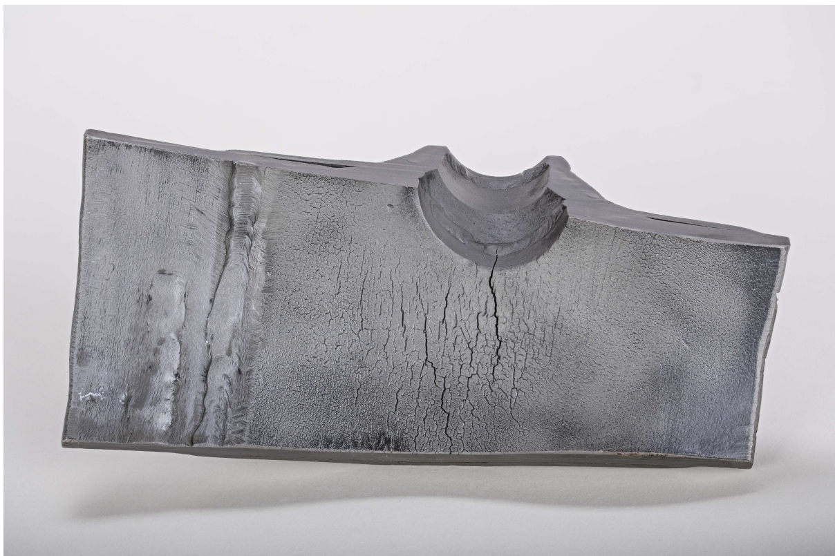
Rysunek 40: Pęknięcia korozyjne naprężeniowe w nieprawidłowo zespawanym kołnierzu wzmacniającym. Fot. CPhoto, Uwe Aranas, Stress-Corrosion-Cracking-caused-by-weld-stress-01.jpg, licencja CC BY-SA 3.0, źródło: Wikimedia Commons .
