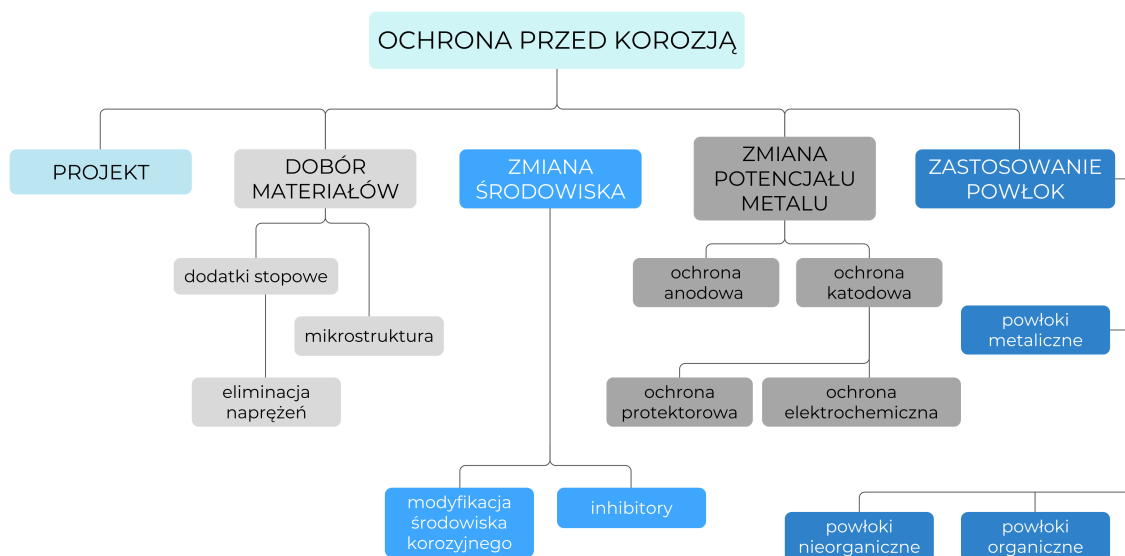
Rysunek 51: Diagram ilustrujący sposoby ochrony przed korozją.
