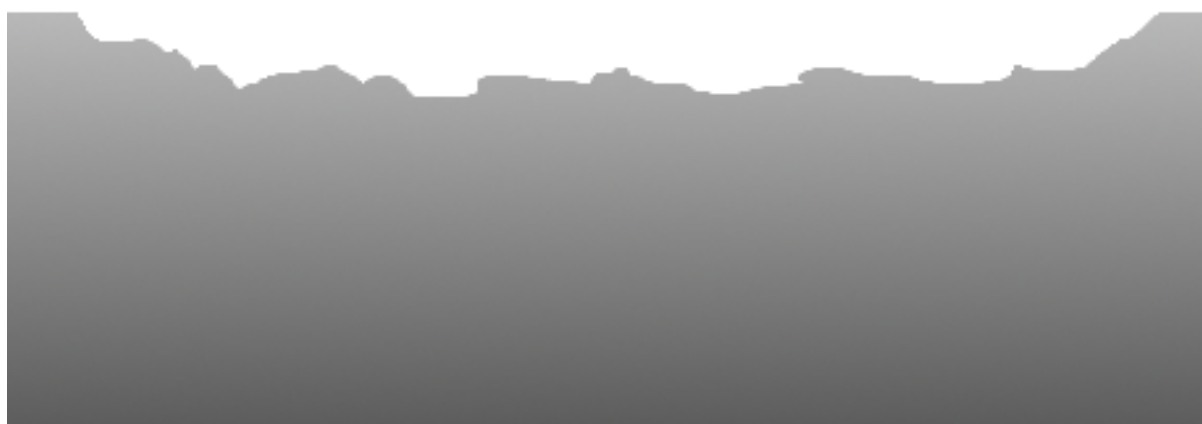
Rysunek 30: Korozja równomierna.
