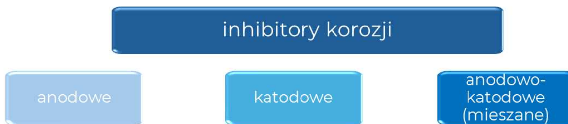
Rysunek 61: Podział inhibitorów korozji ze względu na mechanizm ich działania.
