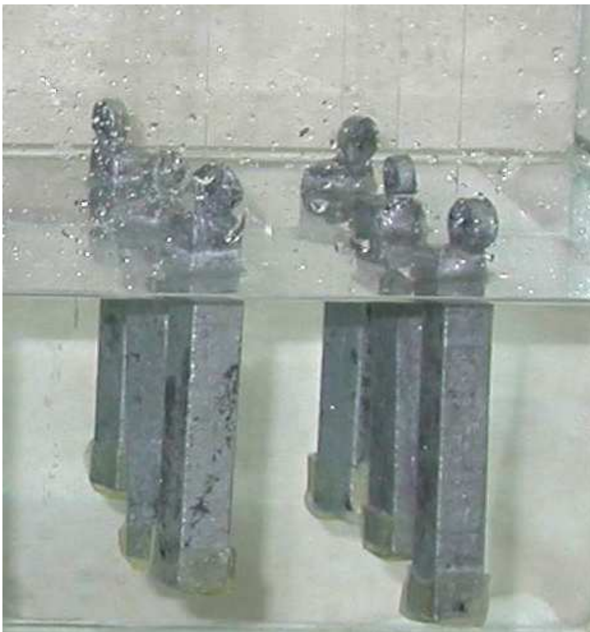
Rysunek 90: Próbkę ocynkowanej stali ekspozowane w roztworze w celu określenia szybkości korozji metodą grawimetryczną.
