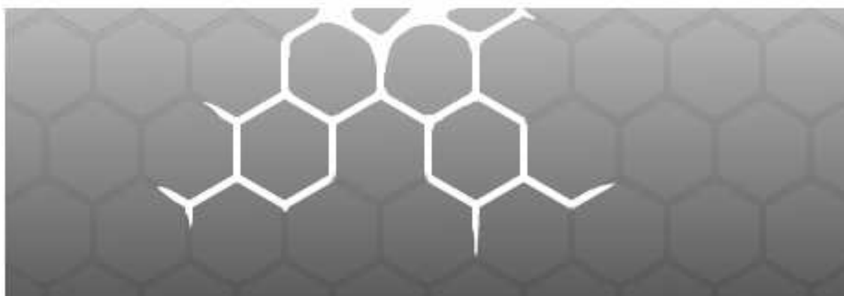
Rysunek 37: Schemat korozji międzykrystalicznej.
