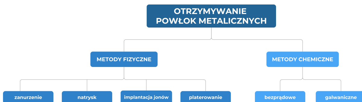
Rysunek 73: Klasyfikacja powłok metalicznych ze względu na technologię otrzymywania.
