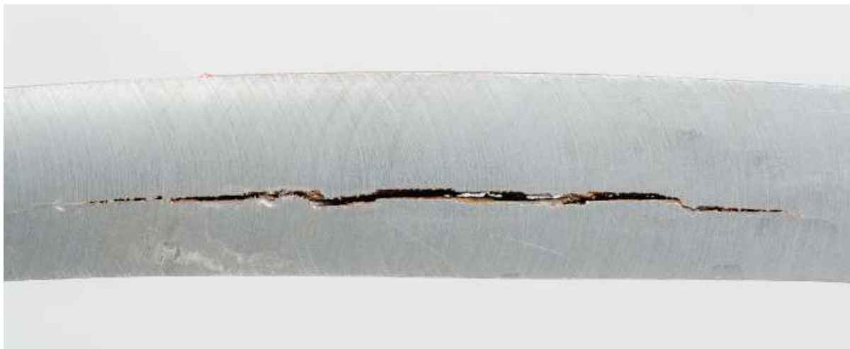
Rysunek 41: Pęknięcie spowodowane korozją wodorową Fot. CEphoto, Uwe Aranas, Steel-with-Hydrogen-Induced-Cracks-01.jpg, licencja CC BY-SA 4.0, źródło: Wikimedia Commons .
