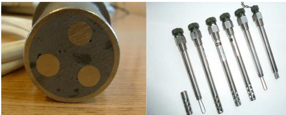
Rysunek 103: Czujniki wykorzystywane do monitorowania korozji: trójelektrodowy czujnik do badań elektrochemicznych (CV, EIS) (po lewej), czujniki do pomiaru oporu polaryzacyjnego (LPR) (po prawej).
