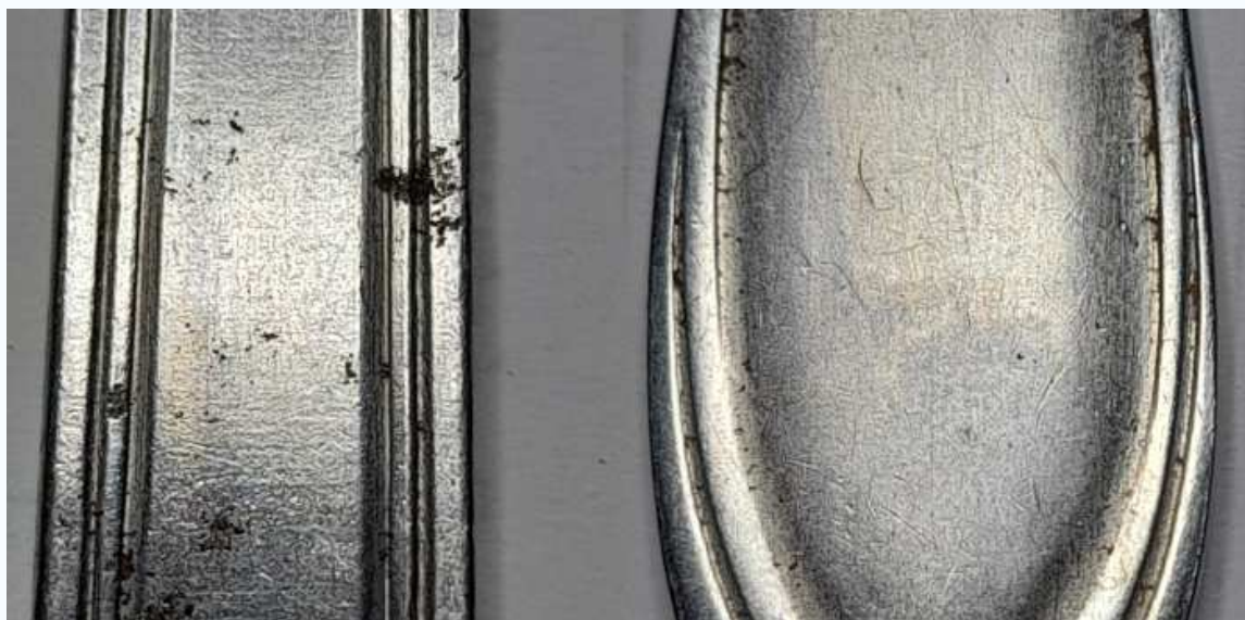
Rysunek 34: Wżery na powierzchni stali nierdzewnej.
