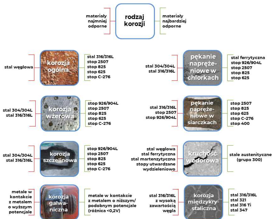
Rysunek 57: Schemat doboru materiałów do typu korozji.
