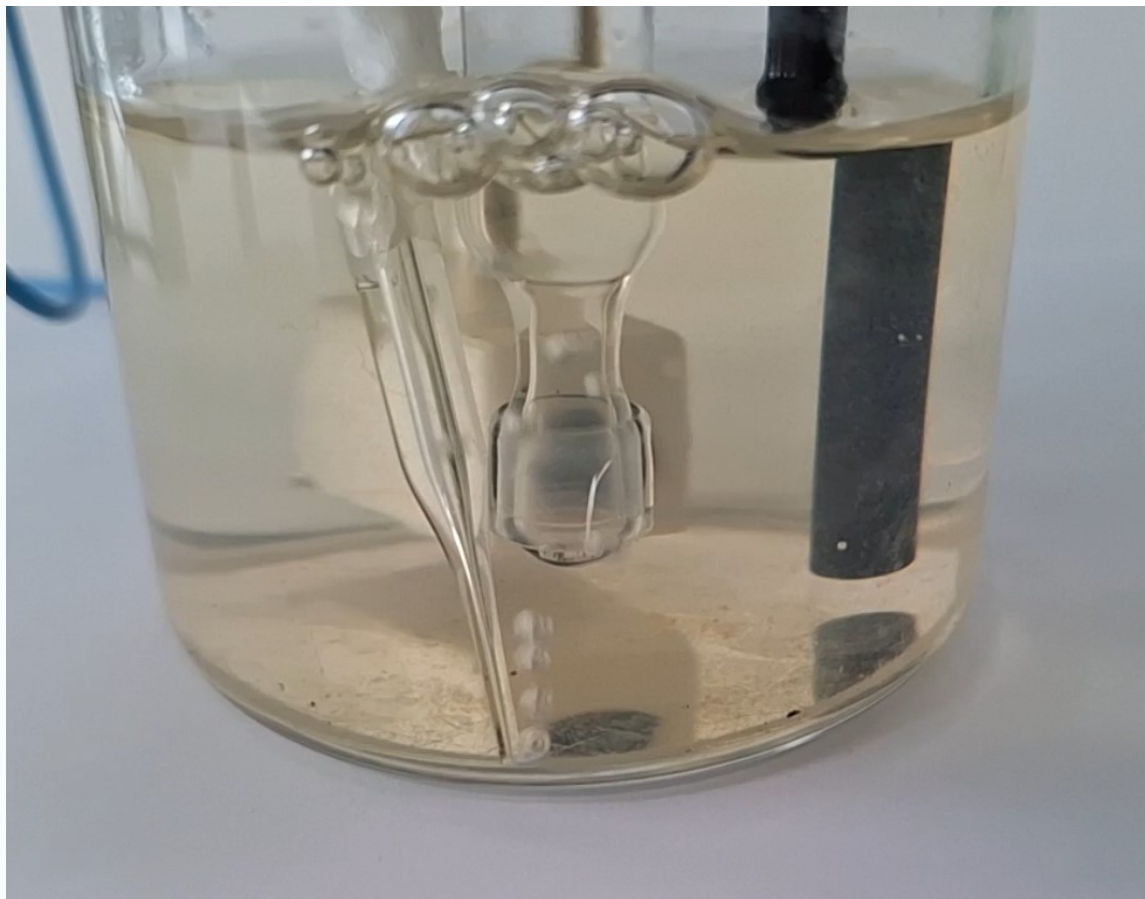
Rysunek 59: Przykład pomiaru elektrochemicznego prowadzonego w atmosferze obojętnej.
